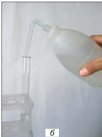
Мал. 10. Промивалка (а) і користування нею (б)
