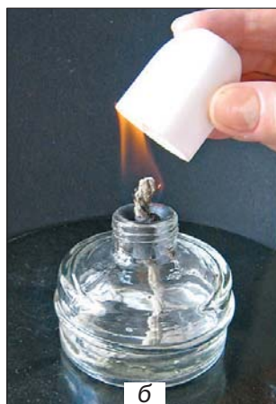
Мал. 15. Спиртівка (а) і гасіння полум'я ковпачком (б)
