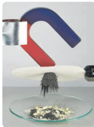
Мал. 13.1. Магнітна сепарація. У такий спосіб на млинах від зерен пшениці відокремлюють дрібні залізні часточки, які могли потрапити до зерна під час збирання комбайном
