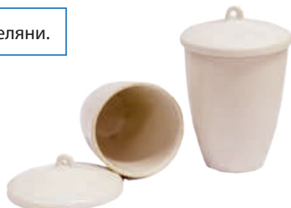
Порцеляновий тигель із кришкою, у якому можна нагрівати й прожарювати тверді речовини
