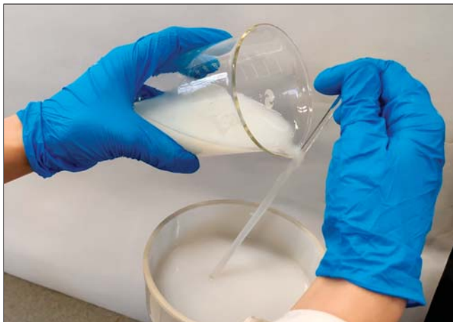
22. Ábra. Folyadék öntése üvegpálcika segítségével
