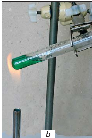
25. Ábra. Oldat hevítése kémcsőben: a — kémcsőfogóban; b — laboratóriumi állványban
