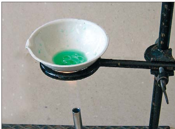
26. Ábra. Oldat hevítése porcelán csészében
