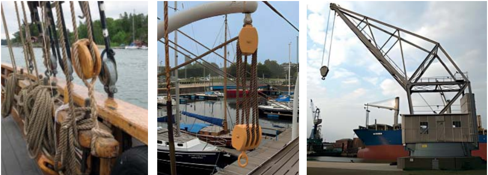
Мал. 34.4. Приклади використання системи блоків
