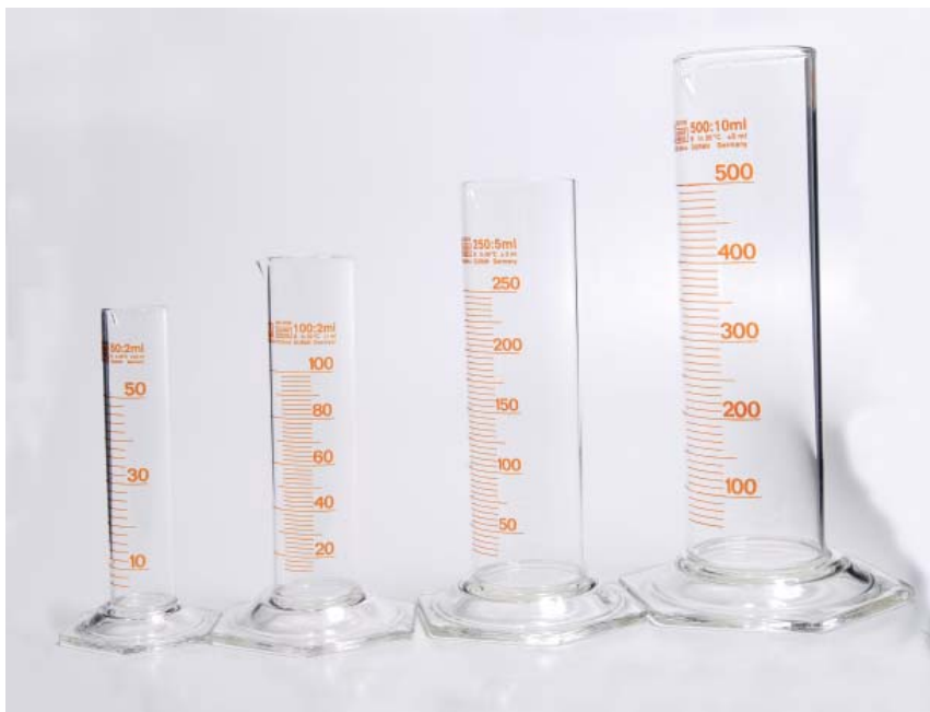
Мал. 5.3. Мензурки з різною ціною поділки шкали
