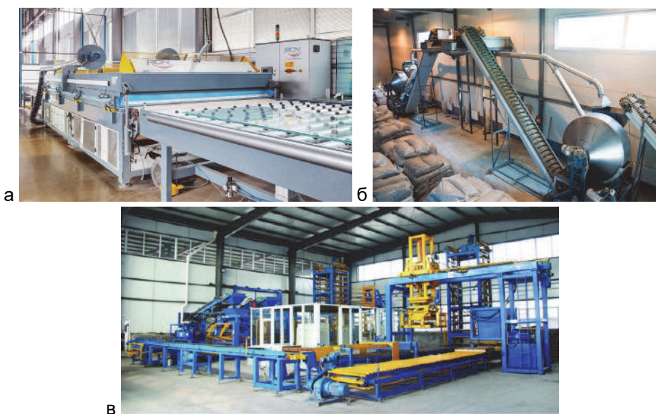
Рис. 2.25. Автоматизовані лінії з виробництва: а) триплексу (багатошарового скла); б) зерноsumішей; в) будматеріалів
