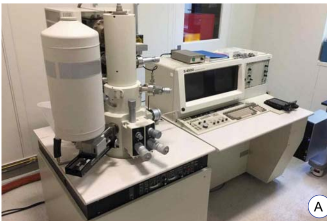
Мал. 4.4. А. Сучасний електронний мікроскоп. Б. Клітина бактерії Bacillus subtilis (українська назва «сінна паличка»; фотографію зроблено за допомогою електронного мікроскопа, збільшення в 73 000 разів)
